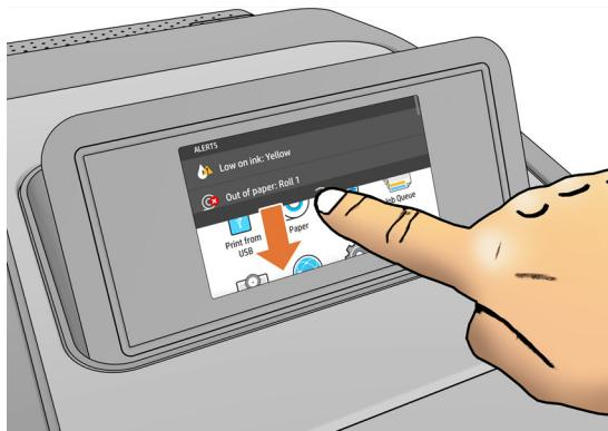
Il pannello frontale è dotato di un'ampia area centrale per la visualizzazione delle icone e delle informazioni dinamiche. Sul lato sinistro è possibile visualizzare tre icone fisse in momenti diversi. Solitamente non vengono visualizzate nello stesso momento.
